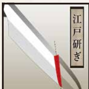
中心線に対し3対7で片側を直線的に、 反対側をハマグリ形に整える、 独自の研ぎ方
