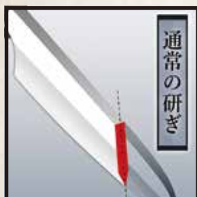
中心線に対し5対5の比率で 左右対象に直線的に尖らせた 一般的な包丁の研ぎ方
